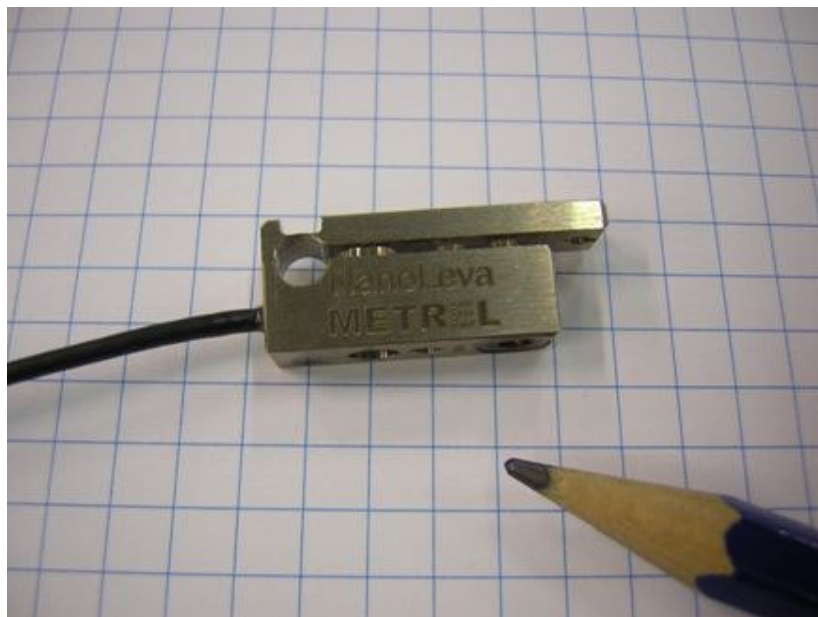
Figura N°3- Piccolo trasduttore denominato NanoLeva
